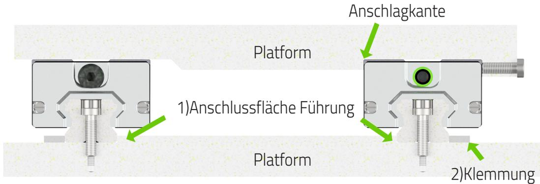
Alternativ kann die Führung auch mit Hilfe einer Hilfleiste und einer Messuhr ohne Anschlagkante ausgerichtet werden. Hierbei ist es essentiell, dass die zweite Führung parallel zur ersten montiert wird. Verwenden Sie hierzu eine Messuhr.
